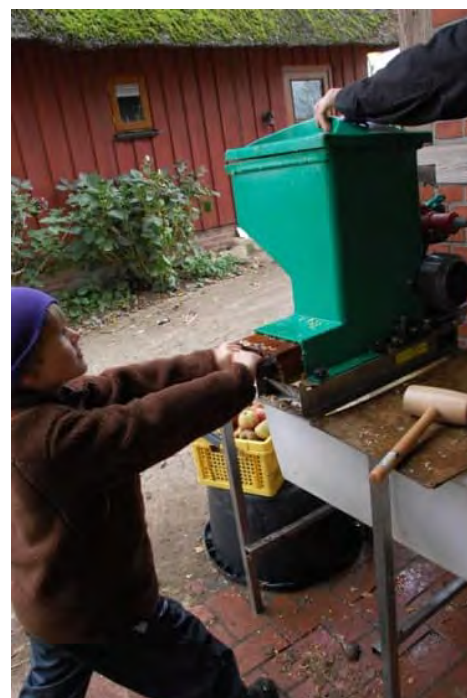
Emil schiebt die Äpfel mit dem Holzklötz ins Schredderwerk – so entsteht die Apfelmaische
